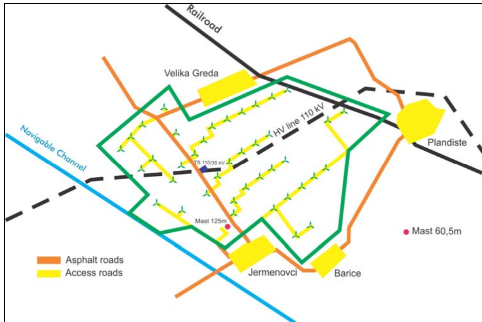
Slika 9 – Vetropark Plandište – lokacija i planirani raspored vetrogeneratora.
